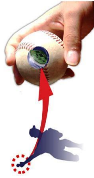
投手が投げると、Bluetoothによってスマホに投球データが転送される。
